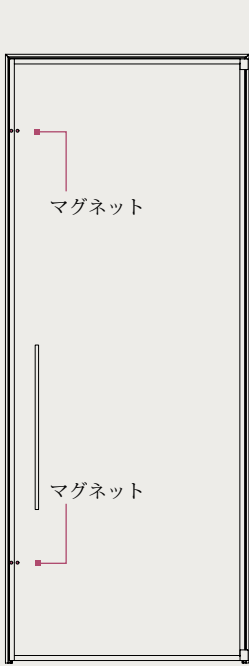
マグネット取り付け No1 シングルピボットガラスドア ■DFRマグホルド 左 or 右
