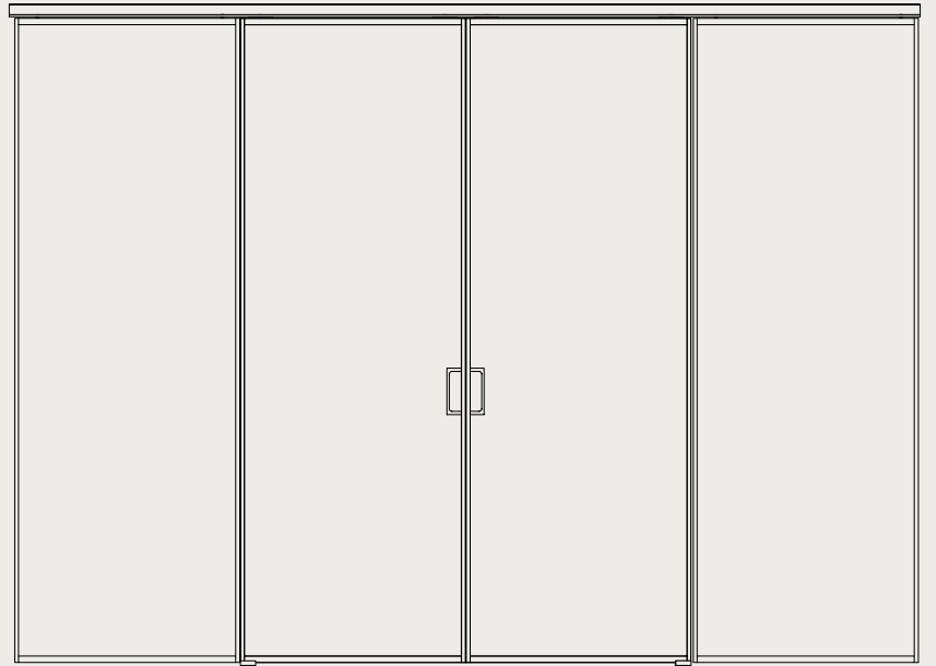
スライド式ドア用アプリケーション No4 固定パネル付き二重引き戸 ■ドアハンドル ■スライドロック
